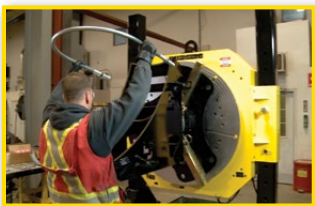
Remove hold down u-bolt.
