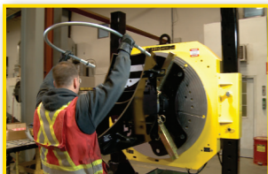
Remove hold down u-bolt.
