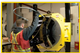
Remove hold down u-bolt.
